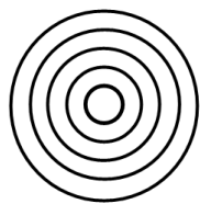
Рисунок 1 – Внешний вид компенсатора. Радиус центрального диска 5 мм; внутренние радиусы концентрических колец, мм: 5, 10, 15, 20; поверхностная плотность \text{г/м}^2 , соответственно: 45, 41, 36, 29, 18.
