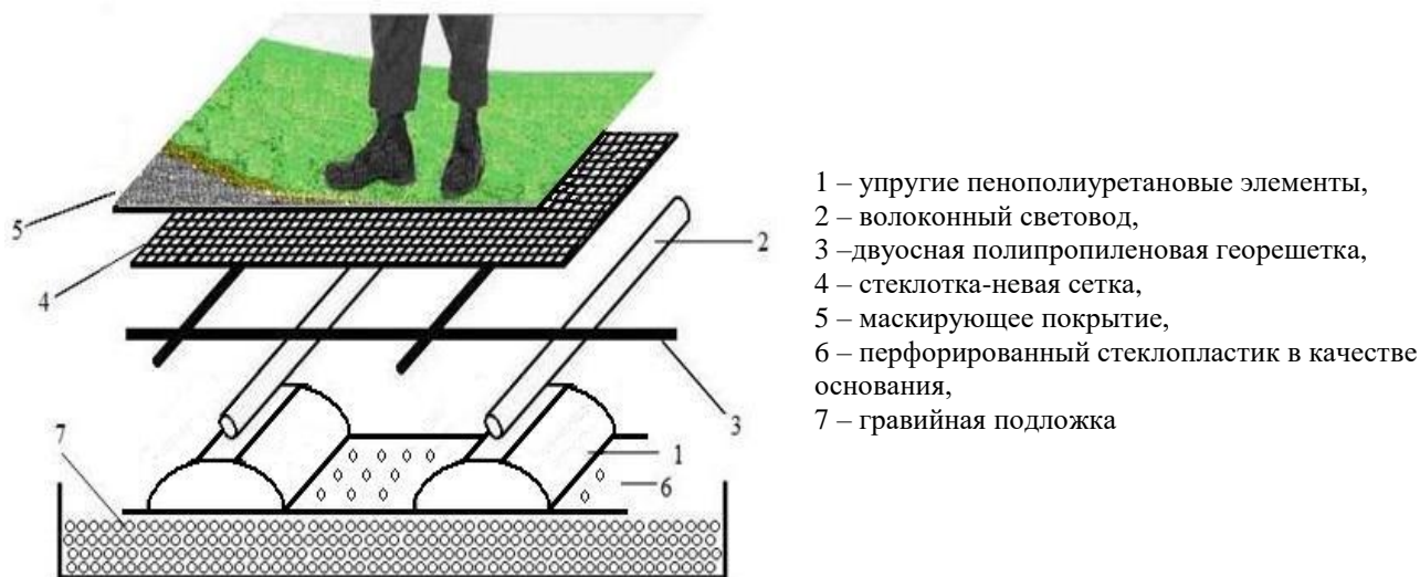
Рисунок 1 – Конструкция чувствительного элемента волоконно-оптической системы охраны периметра
