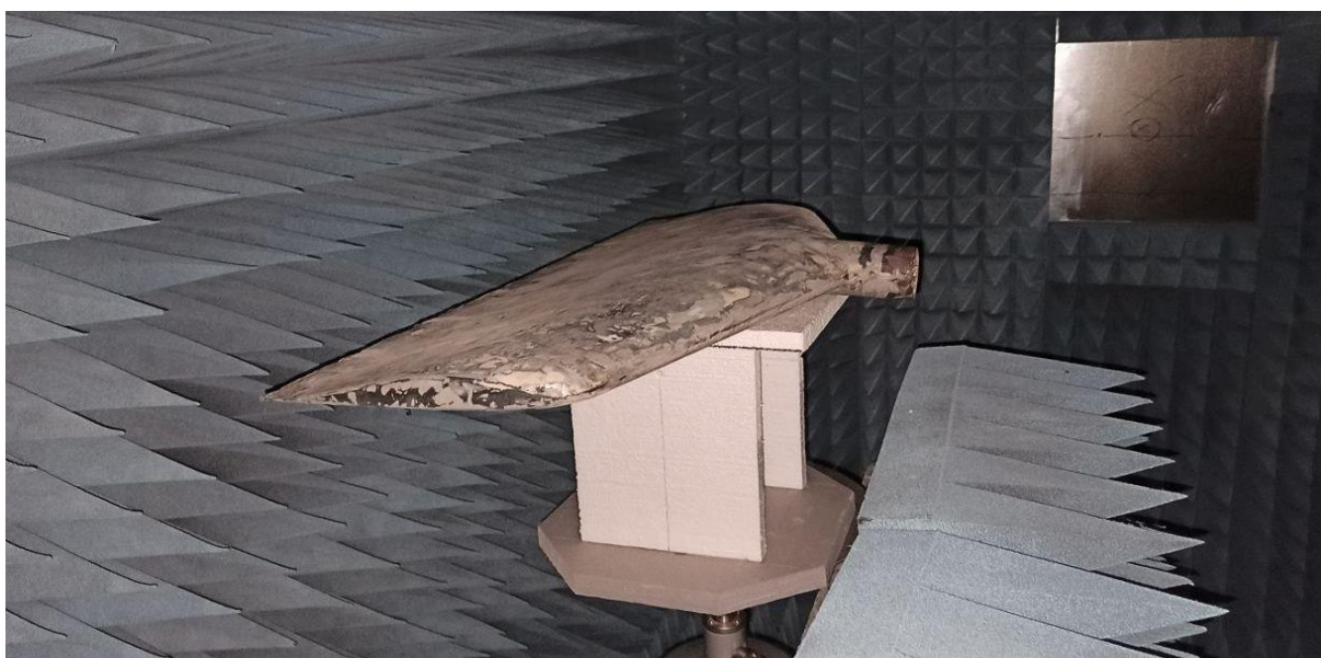
Рисунок 2 – Испытание модели фюзеляжа в безэховой камере на радиотражение
