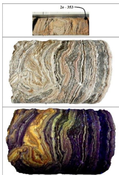
Рисунок 4 – Ультрафиолетовая фотография (внизу) керна скв. 2е месторождения Маха Саракхам, глуб. 353,00 м
