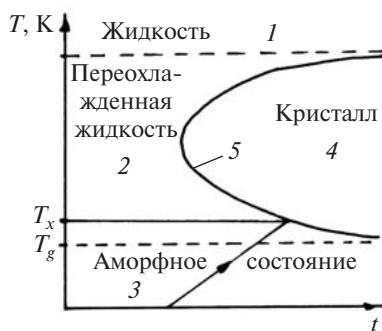
Рис. 1.72. Диаграмма ТТТ металла и нагрев аморфного состояния: 1 – стабильное состояние жидкости; 2 – метастабильное состояние жидкости; 3 – аморфное состояние; 4 – кристаллическое состояние; 5 – линия начала кристаллизации
