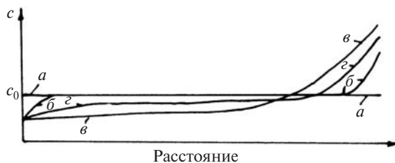
Рис. 1.27. Распределение растворенного элемента вдоль слитка после направленного затвердевания:
