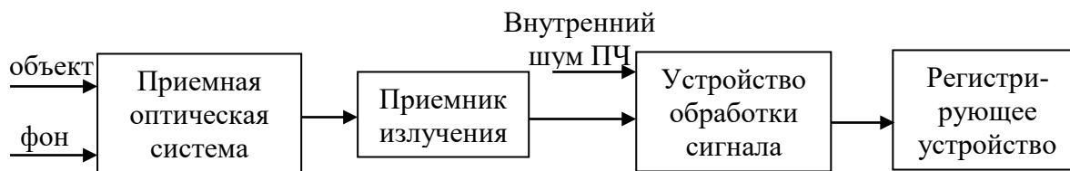
Рис. 1. Общая функциональная схема ОЭС
