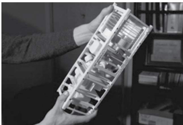
Рисунок 2 – Собранный из трех U-модулей спутник
