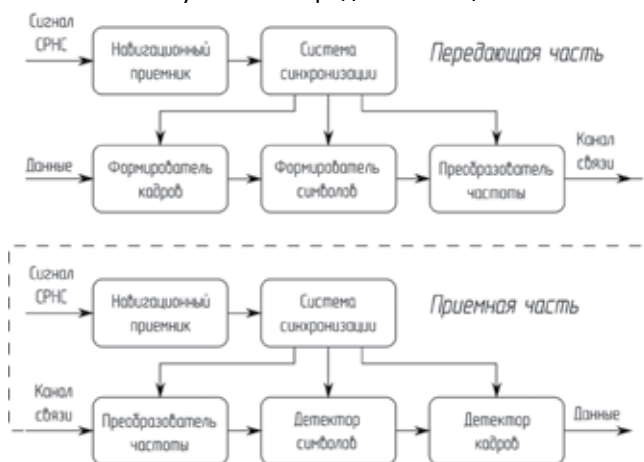
Рисунок 1 – Структурная схема синхронизированной системы связи
