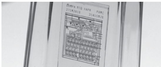
Микросхема на стекле Gorilla Glass до разрушения
