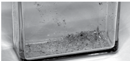
Тысячи частиц бывшей микросхемы после самоуничтожения
