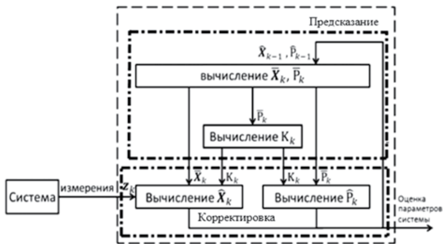
Рисунок 3 – Схема функционирования фильтра Калмана
