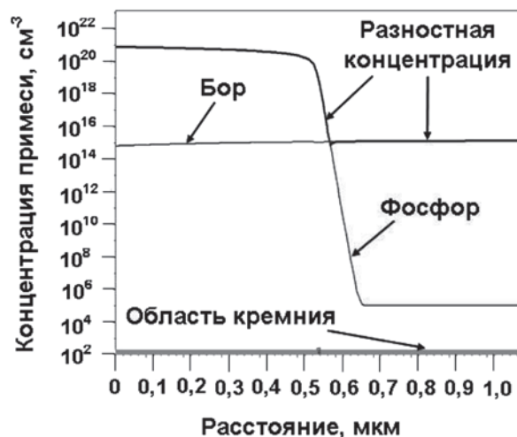
Рисунок 1 – Распределение концентрации примесей в кремниевой подложке p -типа с удельным сопротивлением 10 Ом·см, полученные в результате моделирования диффузионного легирования фосфором
