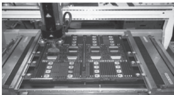
Рисунок 3 – Печатная плата с большой тепловой массой размерами 22×24 мм, установленная на модернизированной паяльной станции
