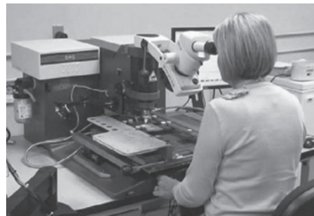
Рисунок 7 – Человеко-машинный интерфейс «оператор – паяльная станция для компонентов 01005»
