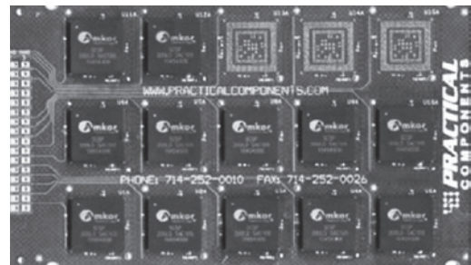
Рисунок 20 – Устройство для тестирования компонентов TMV PoP
