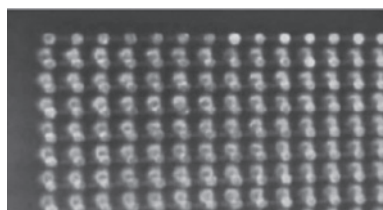
Рисунок 4 – Изображение угловой части 114 мм BGA-компонента в системе технического зрения
