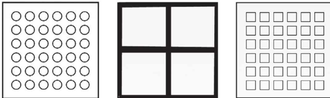
Рисунок 27 – а) круглые отверстия диаметром 1,00 мм и шагом 1,2 мм – покрытие на 50 % [6]; б) квадратные отверстия со стороной 3,10 мм и шагом 3,95 мм – покрытие на 60 % [6]; в) квадратные отверстия со стороной 1,35 мм и шагом 1,5 мм – покрытие на 81 % [6]
