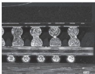
Рисунок 22 – Поперечный разрез, свидетельствующий о сравнительно плохих результатах пайки (при погружении в паяльную пасту)
