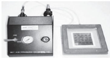
Рисунок 26 – Система для применения трафаретов на несколько компонентов
