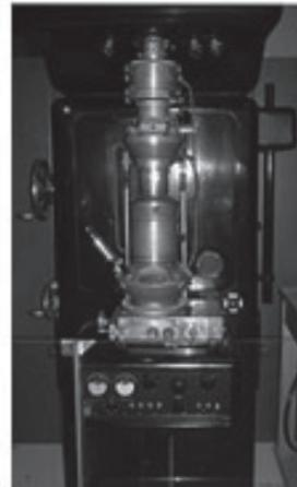
Рисунок 15 – Прототип первого просвечивающего электронного микроскопа (ПЭМ)
