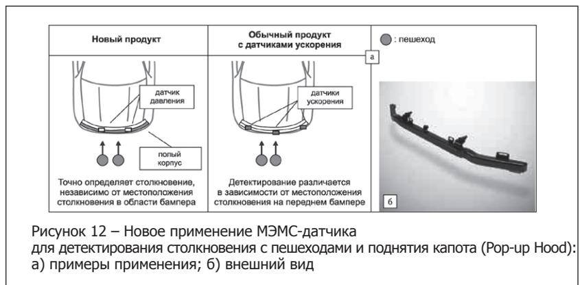
Между капотом и «железными» компонентами под ним (включая двигатель) создается большее буферное пространство. В predetermined скоростном диапазоне при детектировании столкновения пешехода с передним бампером датчик посылает информацию в электронный блок контроля: в момент столкновения над капотом разворачивается подушка безопасности и капот поднимается.
