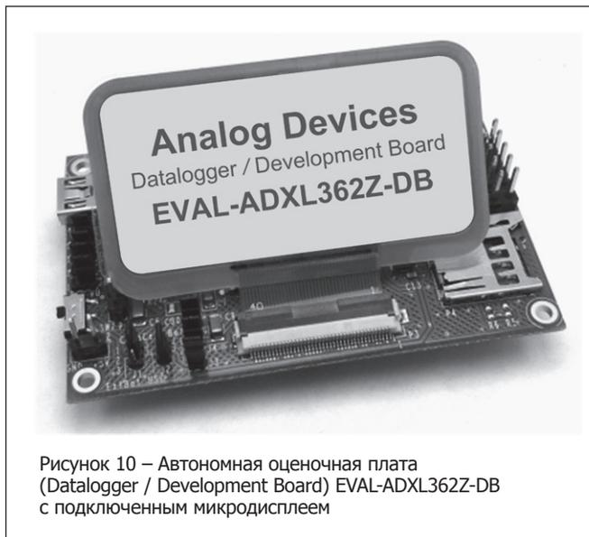
Рисунок 10 – Автономная оценочная плата (Datalogger / Development Board) EVAL-ADXL362Z-DB с подключенным микродисплеем
