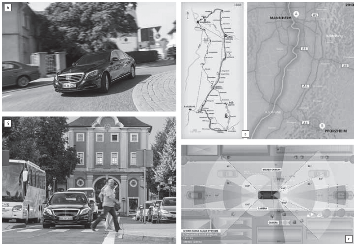
Рисунок 1 – Беспилотный автомобиль S500 Intelligent Drive Mercedes 2013 года: а) автомобиль S500 Intelligent Drive; б) автомобиль в пути; в) маршрут Берты Бенц; г) сетевые сенсорные системы автомобиля на основе радаров и камер
