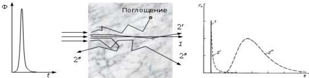
Рис.7.6. Схема распространения сверхкороткого (пикосекундного) лазерного импульса излучения в неоднородной среде
