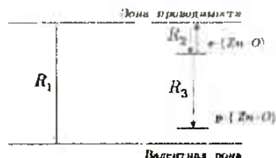
Рис. 1. Схема рекомбинации окситонов, связанных на Zn - O -ловушках
