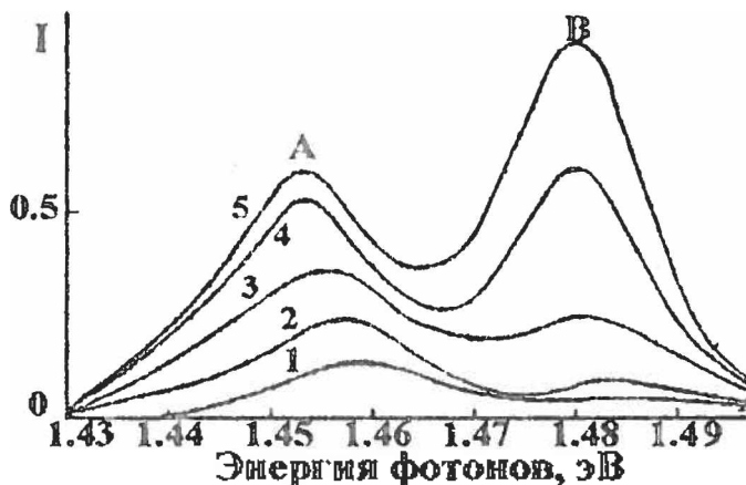
Рис. 1. Спектры получения лазерных диодов на основе GaAs при различных обратных токах (1 – 3 А, 2 – 5 А, 3 – 10 А, 4 – 15 А, 5 – 23 А) и T = 77\text{ К}
