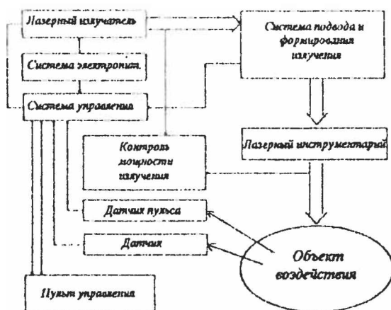
Рис. 4. Блок-схема прибора лазерной терапии
