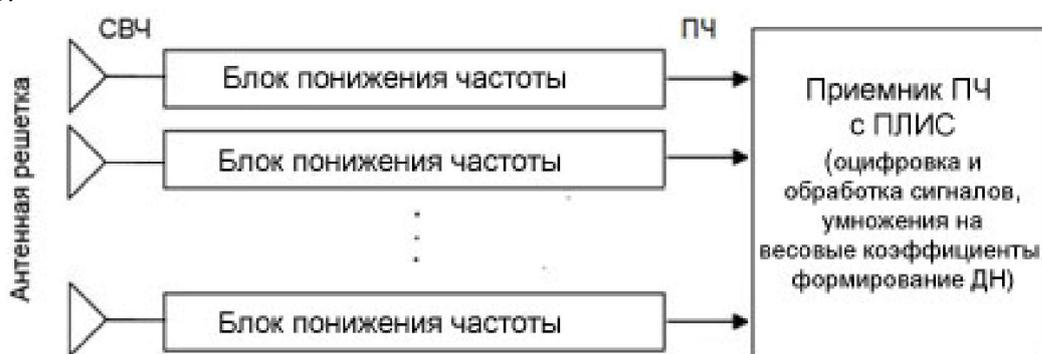
Рис. 1. Принципиальная блок-схема ЦАР
