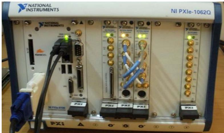
Рис. 2. Внешний вид диаграммообразующей схемы ЦАР на базе модульных приборов National Instruments
