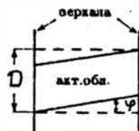
Рис.3. Распределение электрического поля и расходимость излучения в зависимости от толщины активного слоя
