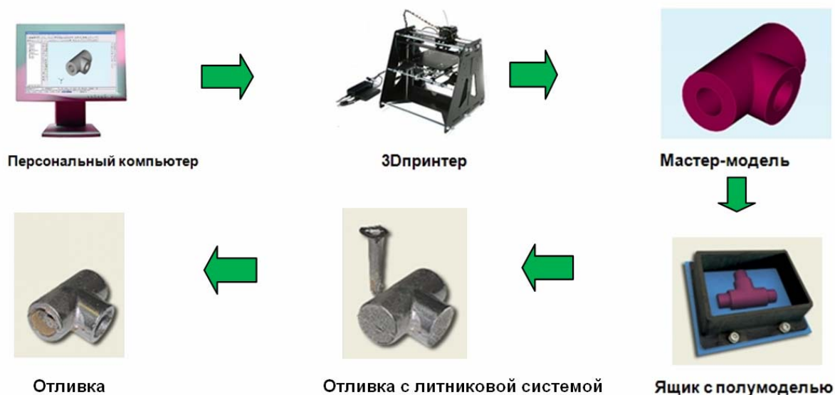
Рис. 2 — Технология получения мастер-моделей и отливок
