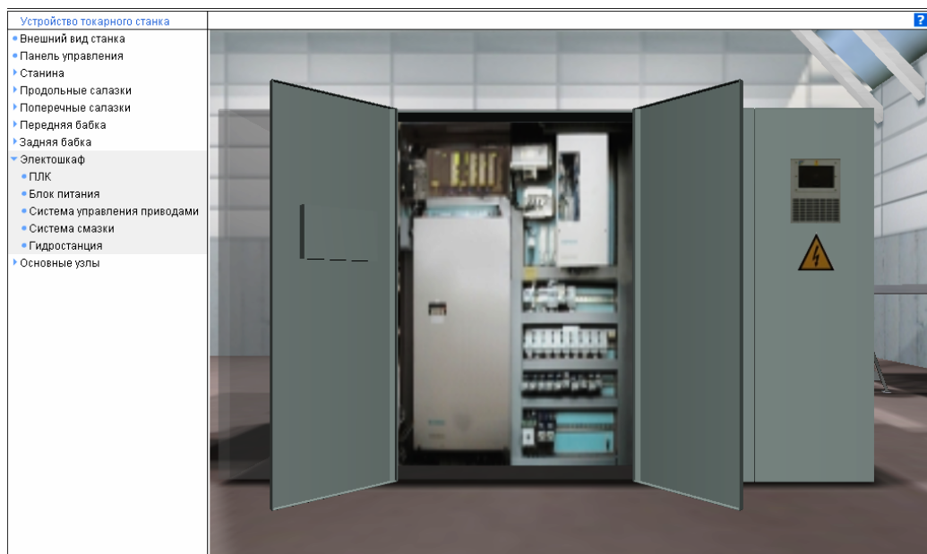
Рис. 5 — Компьютерный эмулятор токарного станка с ЧПУ. Электрошкаф с открытой для изучения секцией с блоком питания
