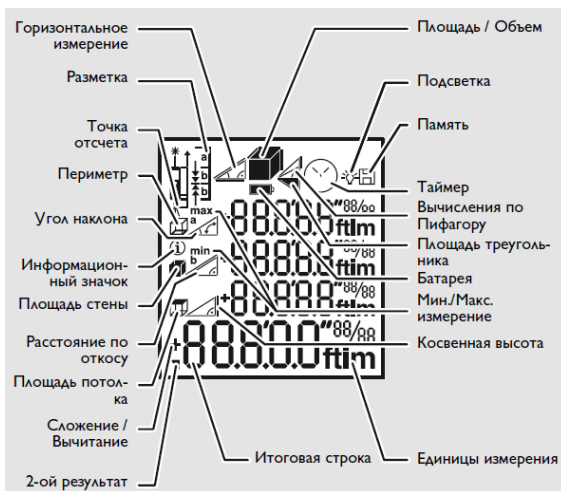
Рис.3. Дисплей Leica DISTO x310
