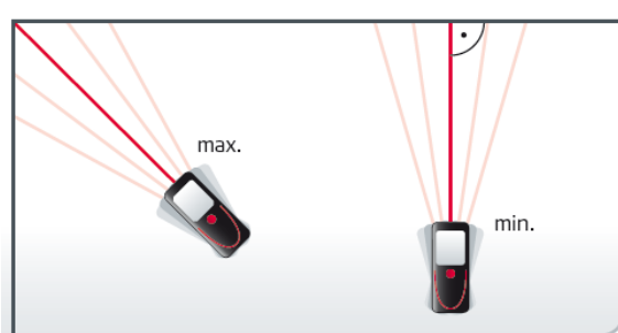
Рис. 5. Схема измерение минимального-максимального расстояния
