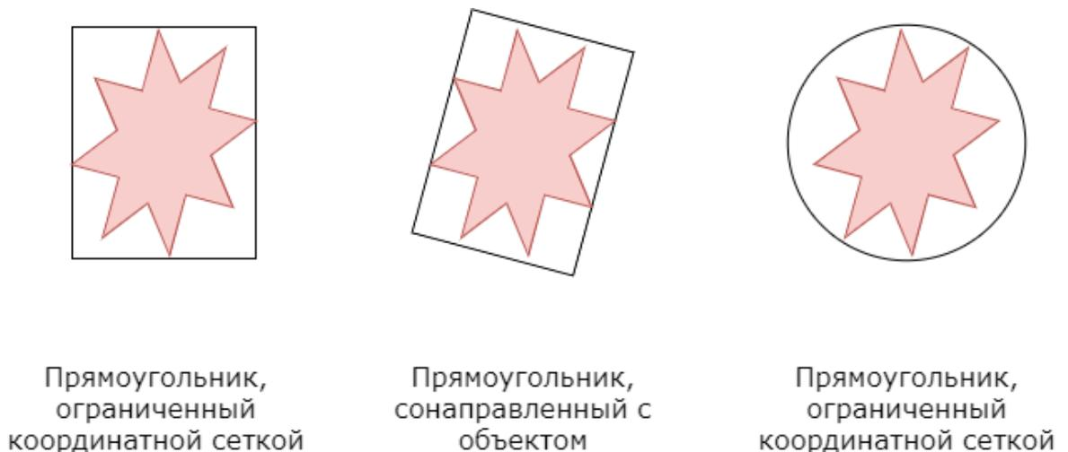
Рисунок 3.10 – Используемые ограничивающие объёмы для задач в двумерном пространстве
