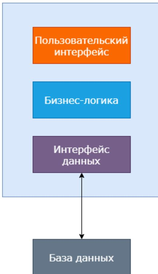
Рисунок 1.2 – Схематический пример монолитной архитектуры
