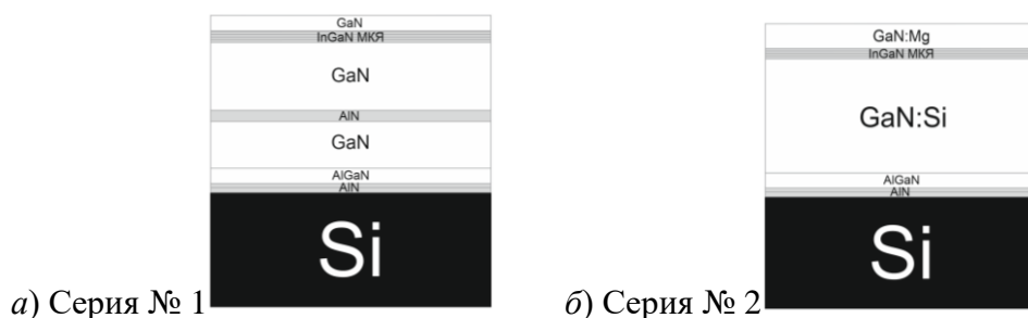
Рис. 1. – Дизайн InGaN/GaN/Si гетероструктур: с МКЯ и одним набором слоёв AlN/AlGaN для снятия напряжений, а также с буферным слоем GaN и низкотемпературными слоями AlN и GaN ( a ); с одним набором слоёв AlN/AlGaN для снятия напряжений ( б ).
