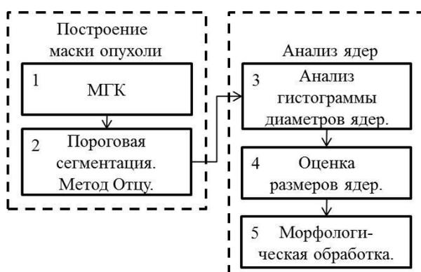
Рисунок 2. – Структурная схема алгоритма сегментации опухоли
