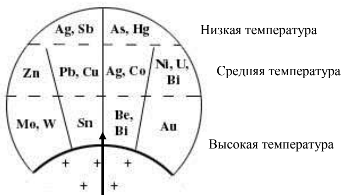
Рис. 15. Схема минерализации жил по мере их удаления от источника гидротермальных растворов и снижения их температуры (И.Т. Бакуменко и др., 2001 г.)
