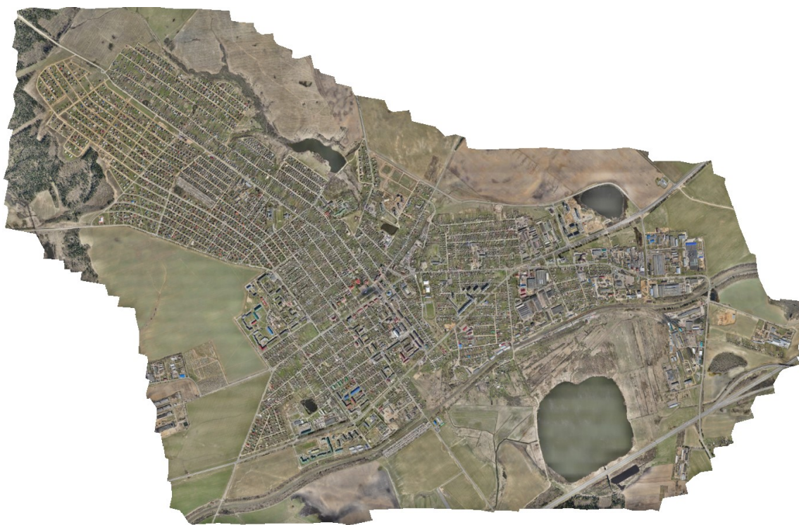
Рис. 2. Ортофотоплан г. Дзержинск, изготовленный по материалам аэрофотосъемки БПЛА (пространственное разрешение – 5 см; среднеквадратичные ошибки: в плане – 2,18 см, по высоте – 3,03 см)
