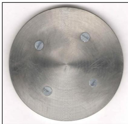
Рис. 2. Общий вид Ti-Al мозаичной мишени для реактивного магнетронного нанесения пленок  $Ti_xAl_{1-x}N$
