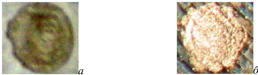
Рис. 1. Микрофотографии лазерно-модифицированного образца дюралюминия Д16Т с окисной пленкой (а,  $\lambda = 266 \text{ нм}, q \sim 3 \cdot 10^7 \text{ Вт/см}^2$ ) и зернистой структурой (б,  $\lambda = 266 \text{ нм}, q \sim 3 \cdot 10^8 \text{ Вт/см}^2$ )
