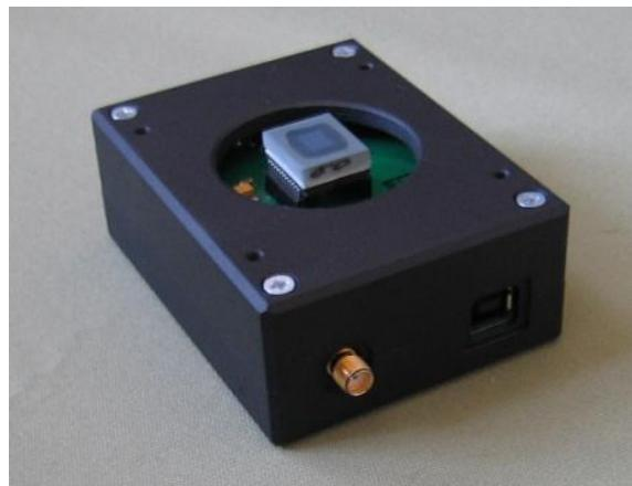
Рисунок 2 – Внешний вид камеры для двумерной регистрации рентгеновского излучения
