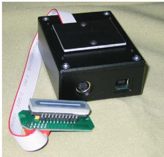
Рисунок 1 – Внешний вид камеры для одномерной регистрации
