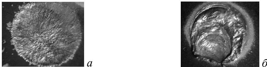
Рис. 3. Оптические микрофотографии поверхности образца, облученного лазером через бипризму Френеля (а) и без нее (б)
