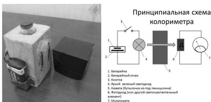
Рис. 1 – Фотоколориметр для выполнения изучения концентрации нитрат-ионов в школьных условиях
