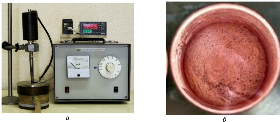
Рисунок 2. – Устройство модификации составов припоев ( а ) и расплав припоя с УНТ в тигле ( б )
