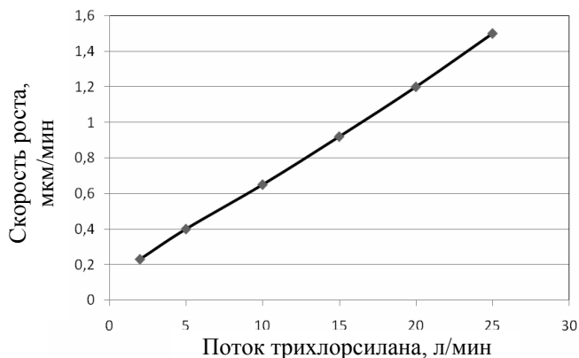
Рисунок 2. – Зависимость скорости роста от потока трихлорсилана при температурах 1200 °С
