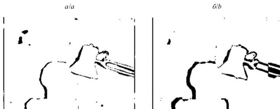
Рис. 2. Ошибочные точки возле границ объектов при размере окна сканирования 3 \times 3 пк (а), 17 \times 17 пк (б)
