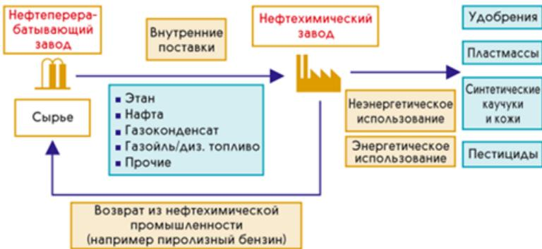
**Рисунок 1.9 — Схема поставок в нефтехимический сектор**
