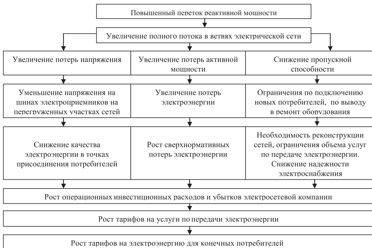
Рисунок – Последствия повышения транспортировки реактивной мощности
