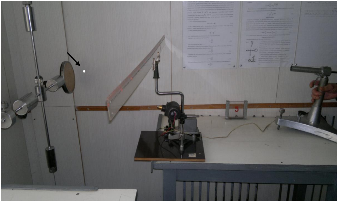
Рис. 4 – Лабораторная установка для определения скорости пули
