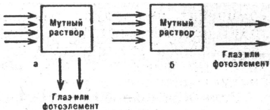
Рис. 31. Схема хода лучей при нефелометрическом (а) турбидиметрическом (б) методах анализа
