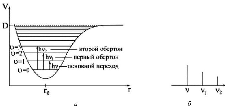
Рис. 50. Кривая потенциальной энергии и уровни колебательной энергии ангармонического осциллятора (а). Схематический колебательный спектр ангармонического осциллятора (б)
