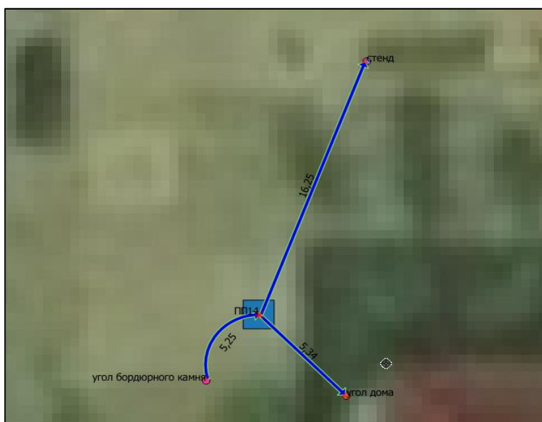
Рисунок 1 – Абрис привязки геодезического пункта в среде ГИС
