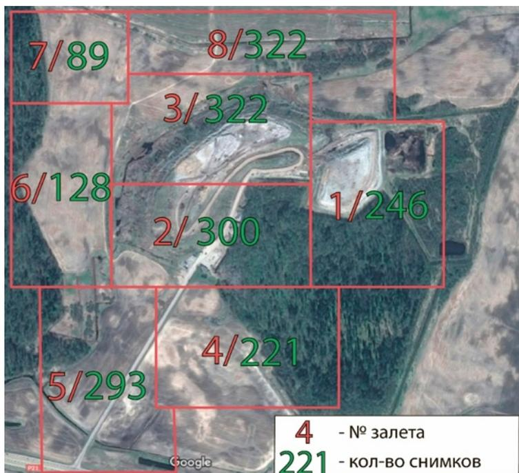
Рисунок 1 – Схема выполнения аэрофотосъемки
