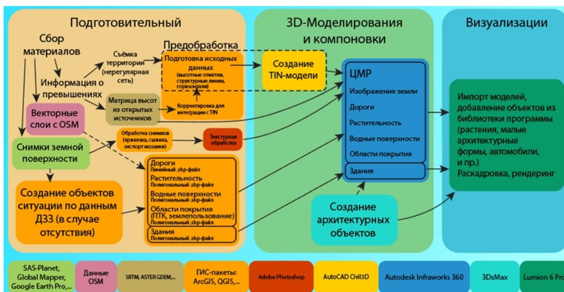
Рисунок 1 – Этапы создания трехмерной модели
