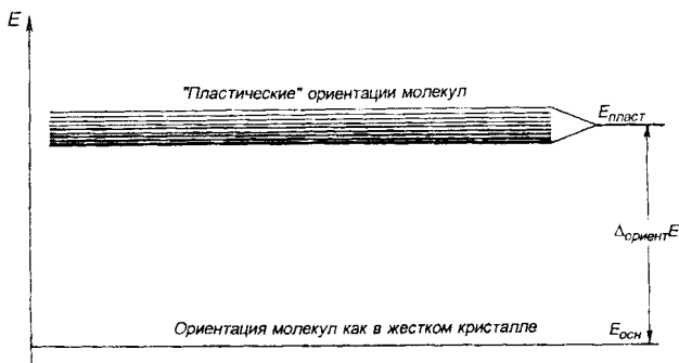
Рис. 3. Модель энергетических состояний с различной ориентацией группы молекул в состоянии пластического кристалла: \Delta_{\text{орент.}} E = E_{\text{пласт.}} - E_{\text{осн.}} — разность между энергией основной и средним значением энергии пластических ориентаций молекул.
