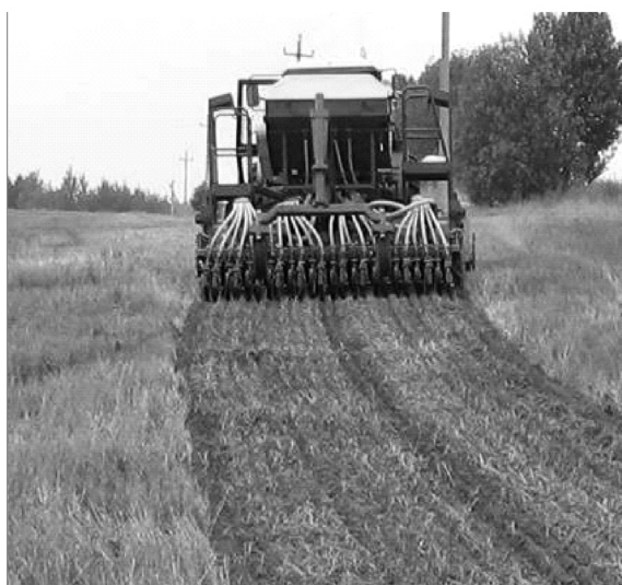
Рис. 7. Обработка машиной МПП-3 дернины с посевом трав (выше) и стерни с посевом рапса (ниже)
