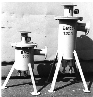
Рис. 7. Фильтр-влажномаслоотделитель, созданный учеными НАН Беларуси для БМЗ
