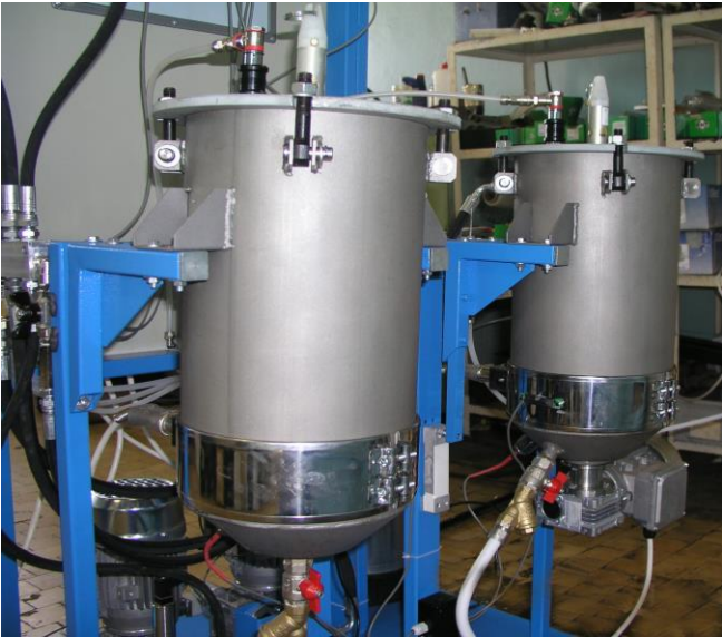
Рисунок 2 – Расходные емкости с системой контроля весового количества компонентов
