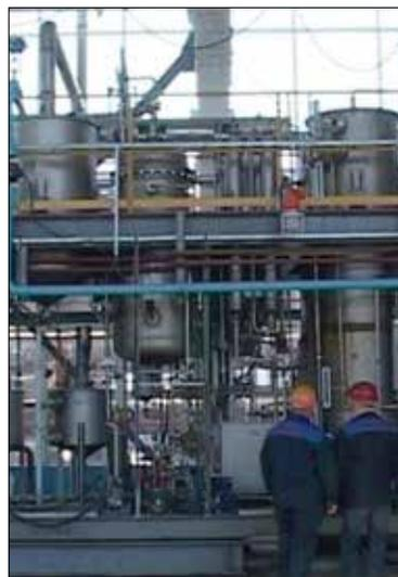
Рис. 3. Установка для производства метиловых эфиров жирных кислот в ОАО «Гродно Азот»
