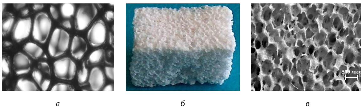
Рис. 7 Матрица ППУ (а), пористая ГА керамика (б), микроструктура ГА керамики (в)
