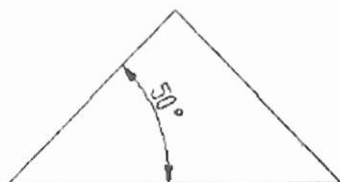
Рис. 2. Чертеж, на котором изображение не соответствует размеру
