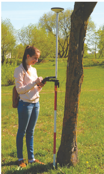
Рис. 4.10. Пример работы со вторым GPS-приемником в процессе кинематической съемки в режиме Stop-and-go
