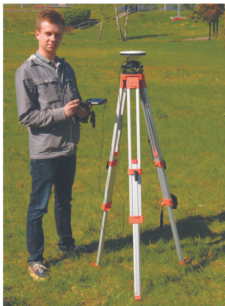
Рис. 4.4. Пример установки GPS-системы на одном из концов базисной линии
