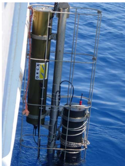
Рис. 5. Извлечение спектрометра после глубоководной долговременной миссии
