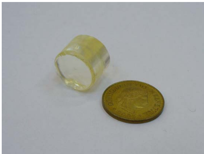
Рис. 1. Первый сцинтилляционный кристалл вольфрамата свинца
