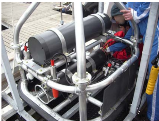
Рис. 2. Спектрометр, размещенный в составе глубоководной исследовательской станции MEDUSA
