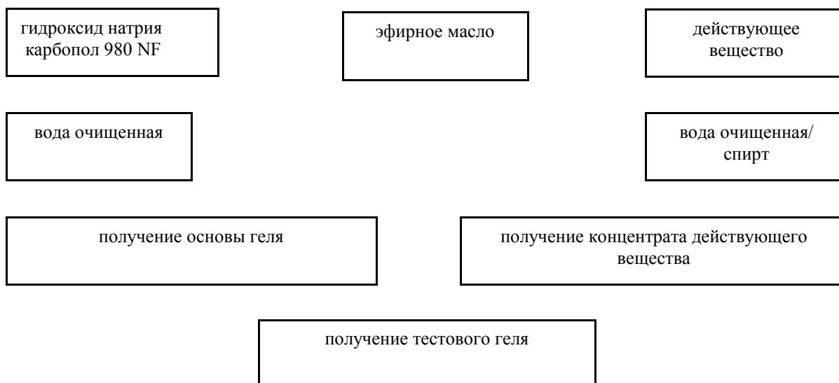
Рисунок 13 – Технологическая схема получения гелей с церкарицидными компонентами
