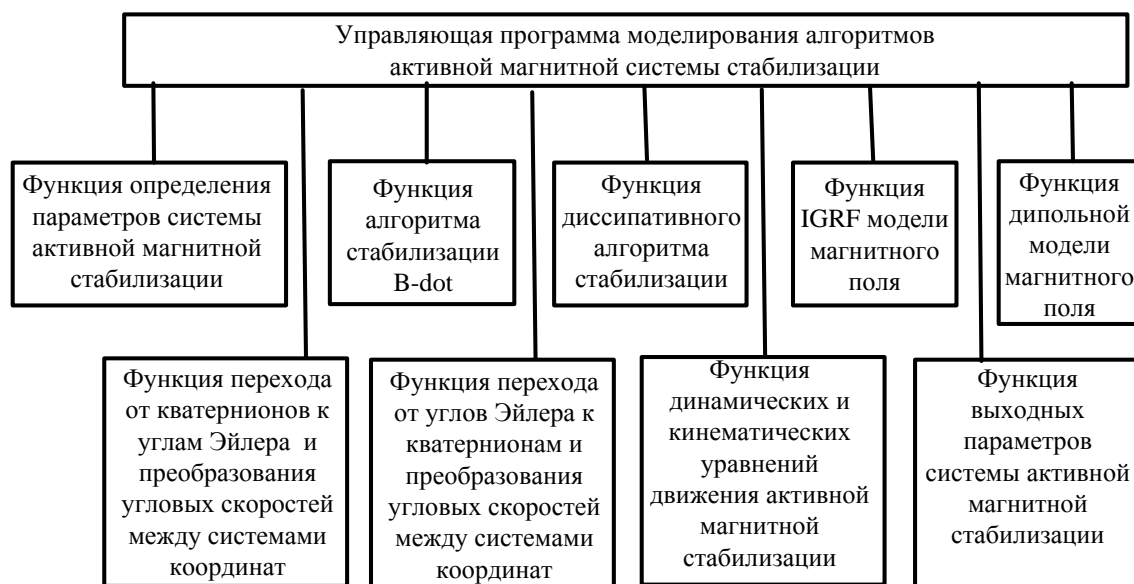
Рис. 1. Структурная схема ПО моделирования алгоритмов активной магнитной системы стабилизации СМКА
