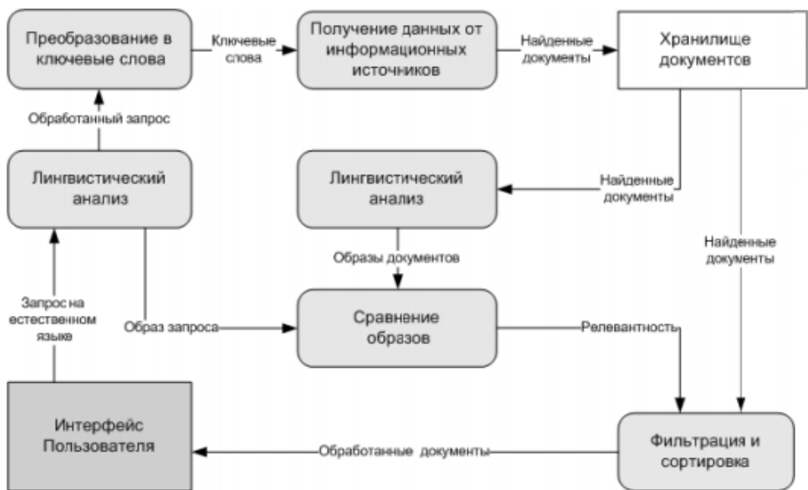
Рис. 2 Схема работы интеллектуальной системы Exactus
