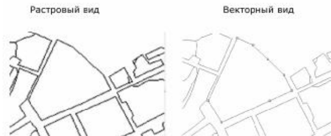
Рис.7. Растровая и векторная модели пространственных данных, используемые в ГИС
