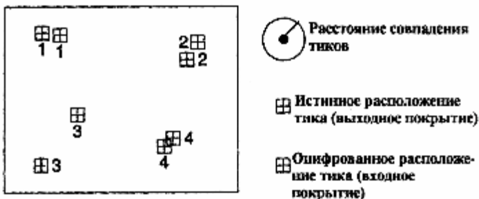
Рис.19. Ошибка регистрации тиков при геопривязке покрытия в ГИС ARC/INFO [1]
