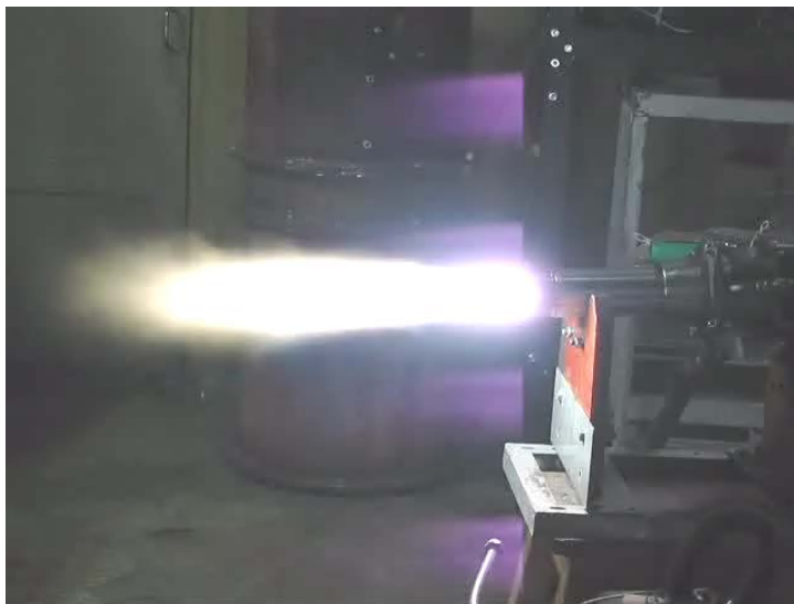
Рисунок 6.3 – Плазматрон переменного тока РРТ-250 (250 kW)
