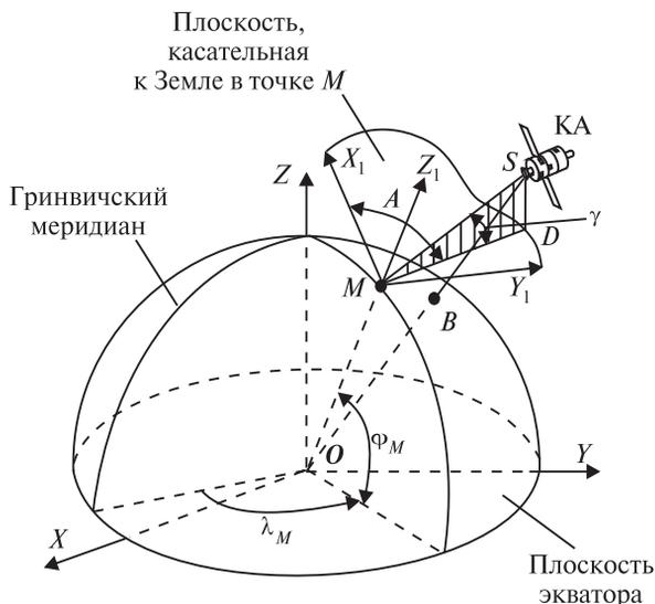
Рис. 10. Топоцентрическая пунктовая система координат
