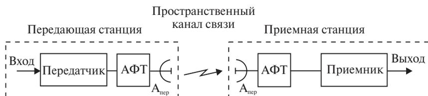
Рис. 13. Линия спутниковой связи
