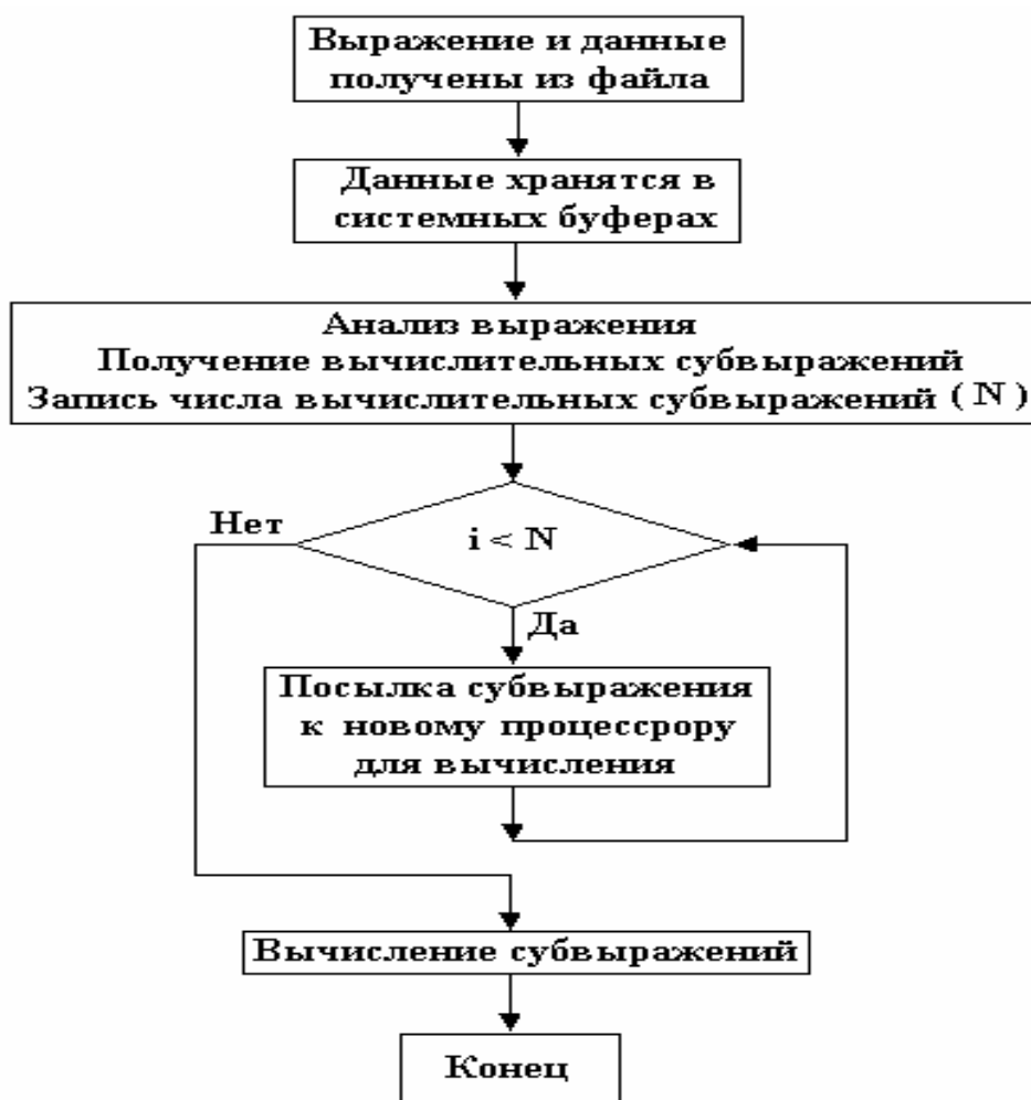
Рис. 1. Схема алгоритма преобразования последовательного арифметического выражения на параллельные системы
