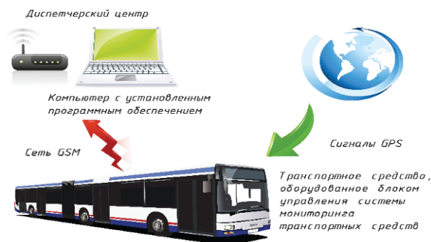
Рис. 1 – Модель работы системы мониторинга транспортных средств
