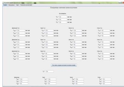
После нажатия на кнопку «Рассчитать средние значения и построить график» программа выводит средние значения плотности потока гамма-излучения для каждого материала каждой толщины и строит график зависимости вида  $\ln K = f(x)$  ( $K = n_{\text{ср}} / n_{\text{ср}} -$  коэффициент ослабления) для каждого исследуемого защитного материала.
